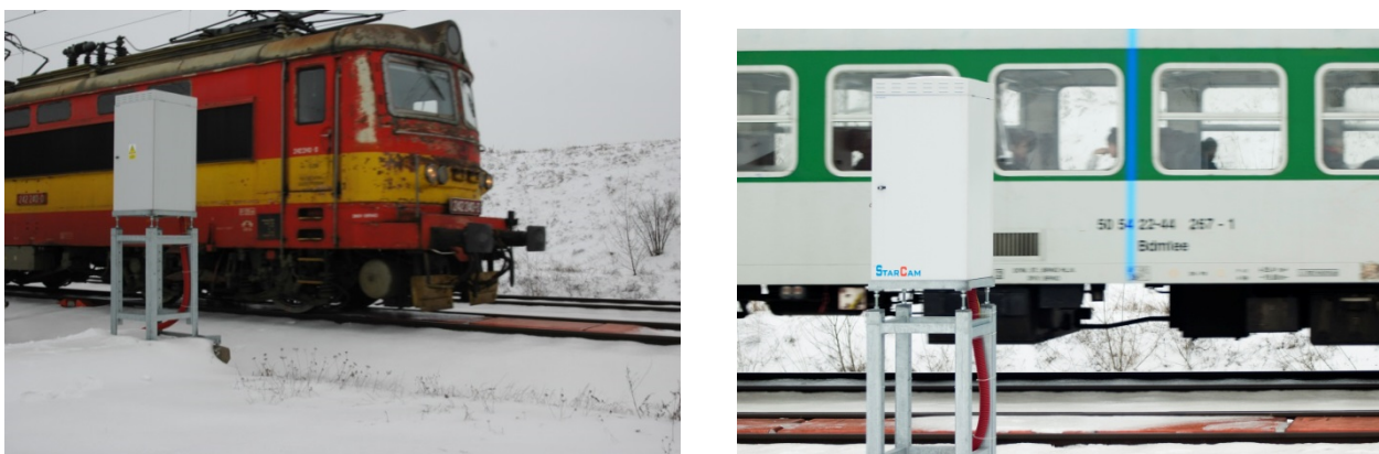
Obr. 4 Systém StarCam pro automatické čtení čísel vozidel za jízdy.
